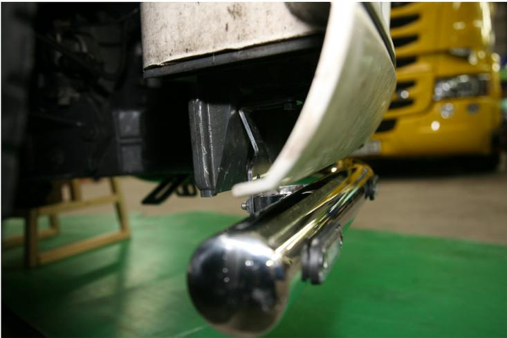
3. Zeichnen sie mit Reißnadel oder Kreide die Löcher der vorderen Halter am Stoßstangenträger an.
