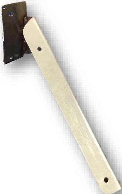
**Bild 2:** Danach die äußeren beiden Halter an der Sonnenblende anschrauben, ausrichten und am Fahrerhaus anzeichnen.
