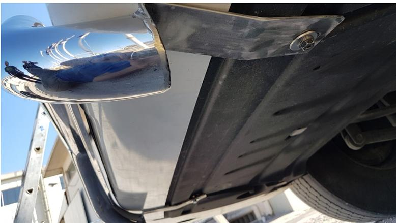
4. Ziehen sie die beiden Schrauben handfest an. Sollten die Schrauben zu kurz sein, verwenden sie M8-Edelstahlschrauben aus dem Fachhandel.
