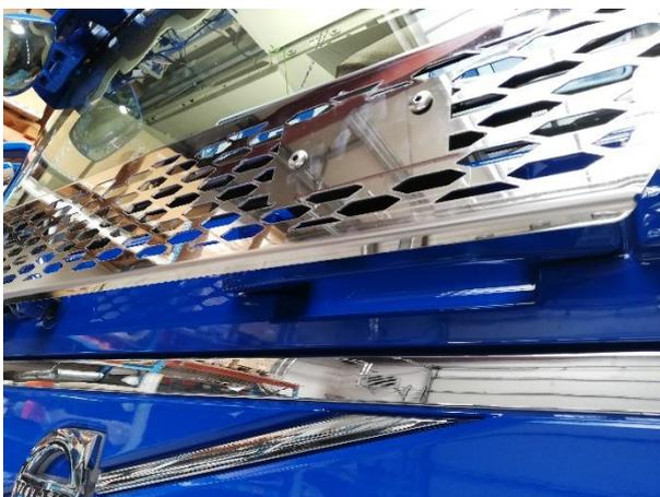
Befestigung des Gitters am vorderen Halter
