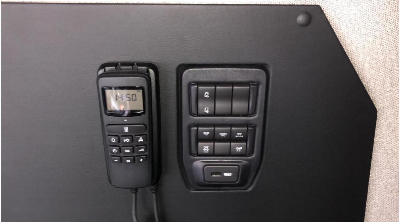
werden. Die Fernbedienung und die Standheizung werden dann einfach wieder befestigt, Die Schrauben werden dann mit den mitgelieferten Deckeln verdeckt. Beleuchtung wird unter dem Bett angeschlossen, dort ist eine Steckdose oder sie schließen es an eine andere beliebige Steckdose an. Der Einbau dauert circa 20 Minuten.
